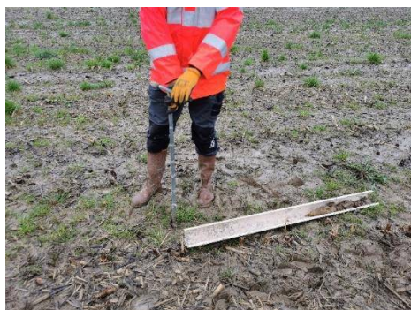
Réalisation de sondage à la tarière (Source : Eau-Méga)
