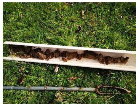
Réalisation de sondage à la tarière (Source : Eau-Méga)
