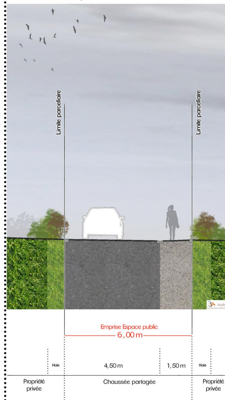
Les voies d'accès aux placettes sont des voiries de desserte circulées à double sens. La chaussée, de 6 mètres d'emprise, fonctionne en espace partagé : une séparation est opérée par un caniveau et/ou un matériau différent de l'enrobé pour matérialiser l'espace de circulation des modes doux sur une largeur d'1,50 mètre minimum.
